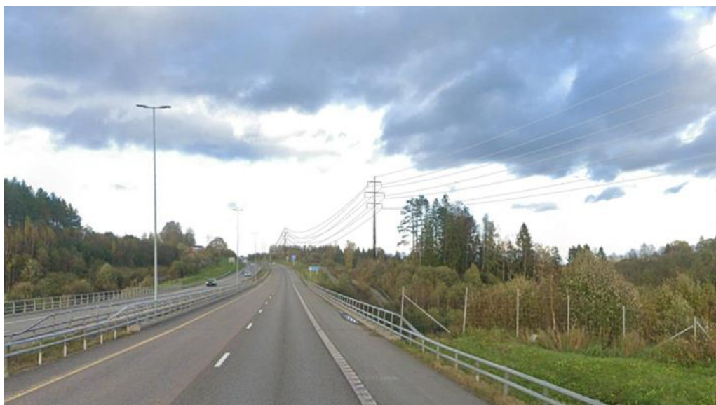
Fig. 7. Visualisering viser at linene kommer høyt over bekkedraget og at det er ikke nødvendig med skogrydding innenfor fredningsområdet.
